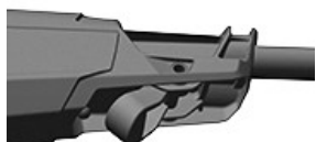
Рычаг блокировки телескопической регулировки вручную
