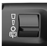
Рычаг скорости правого/заднего стеклоочистителя/стеклоомывателя
