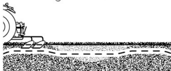
Bei variierenden Bodenverhältnissen führt ein mittlerer Wert zu geringeren Tiefenvariationen.
