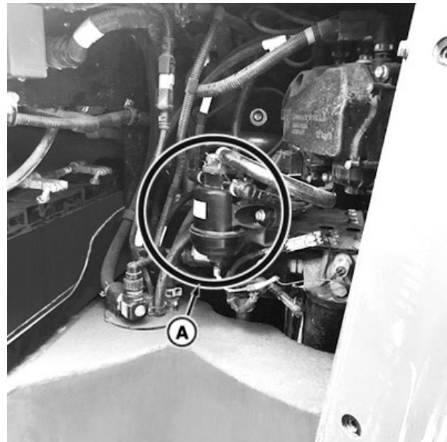
RXA0163952—UN—24JUL18 Der DEF-LeitungsfILTER (A) befindet sich im Batteriefach.
