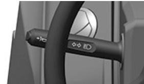
Hebel für Beleuchtung
