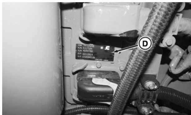
Variklio valdymo modulio (ECM) duomenų plokštelė (D) yra kairiojoje variklio pusėje (ECM priekyje)
