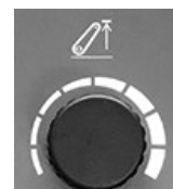
RXA0168029—UN—17MAY19 Prikabinimo įtaiso viršutinės ribos reguliavimo rankenėlė
