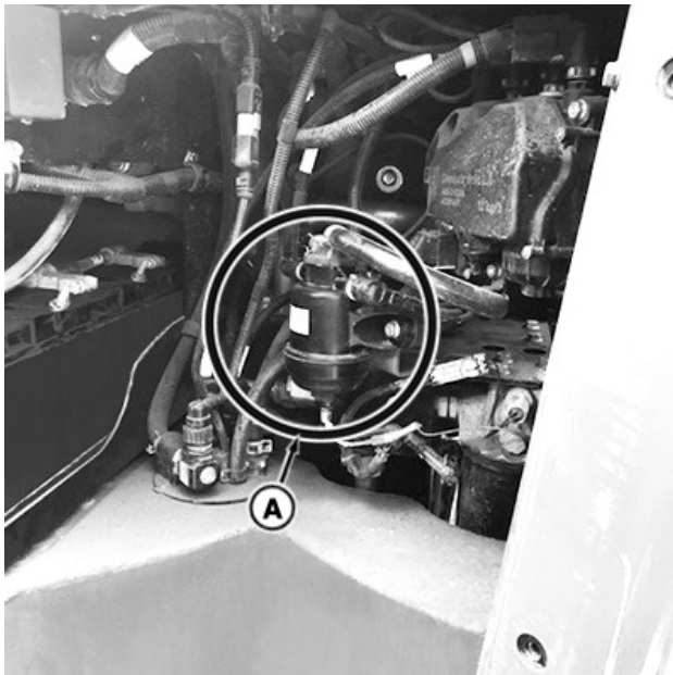
RXA0163952—UN—24JUL18 A soros DEF szűrő (A) az akkumulátortér belsejében található.
