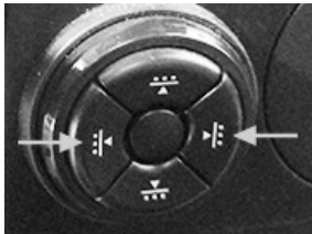
RXA0167333—UN—03APR19 Deréktámasz toldat vezérlés - Ultimate
