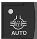
RXA0168428—UN—30MAY19 Botão do Bloqueio do Diferencial Automático
