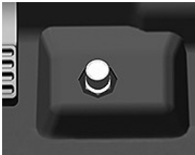
Interruptor do Bloqueio do Diferencial no Piso
