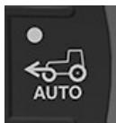
RXA0168426—UN—30MAY19 Botão da Tração Dianteira Automática
