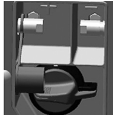
Zaciski połączeniowe akumulatora znajdują się w pobliżu schodków ciągnika.
