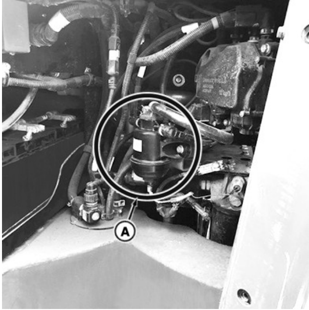
RXA0163952—UN—24JUL18 In-line filter DEF (A) sa nachádza vo vnútri batériového priestoru.
