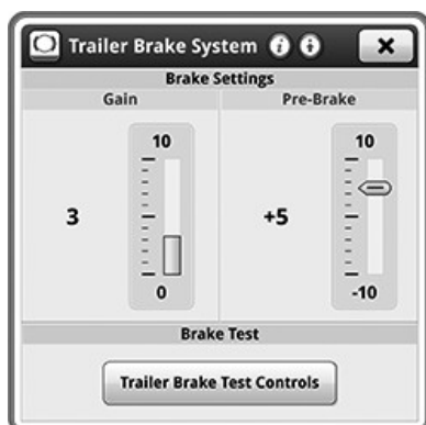
RXA0177625—UN—28APR20 Exemple de système de freinage de la remorque
