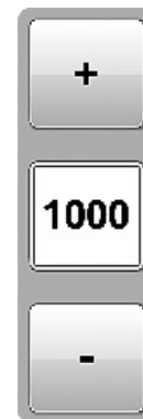
Réglage du régulateur automatique de régime de prise de force arrière
