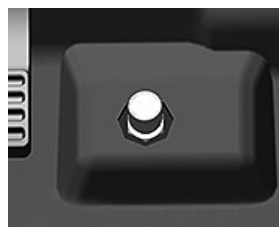
RXA0177202—UN—13APR20 Contacteur au plancher de blocage du différentiel
