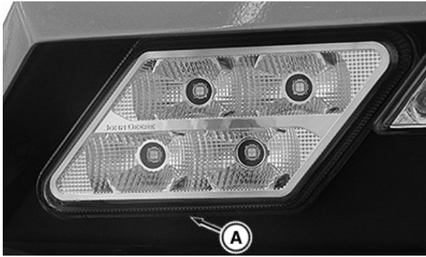
RXA0172759—UN—03DEC19 Phare sur pavillon—Option d'éclairage à LED illustrée
