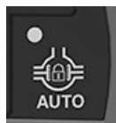
Bouton de blocage automatique du différentiel
