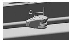
Commande de fermeté de la suspension
