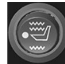
Commande d'intensité de la ventilation/du chauffage - Ultimate
