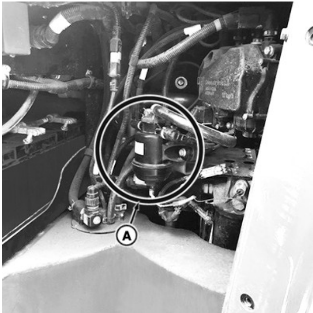
RXA0163952—UN—24JUL18 Le filtre d'urée DEF en ligne (A) se trouve à l'intérieur du compartiment de batterie.
