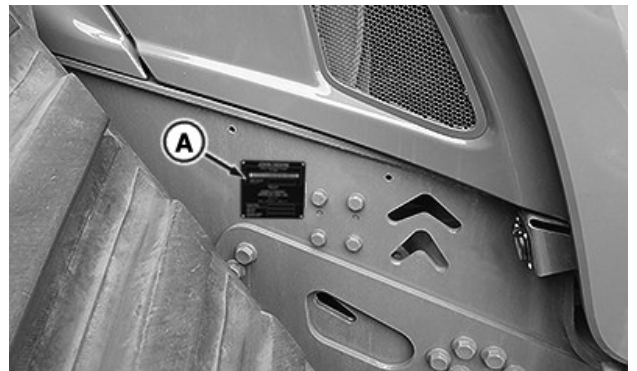
A Placa do Número de Identificação de Produto (A) Está no Lado Direito da Estrutura do Trator
