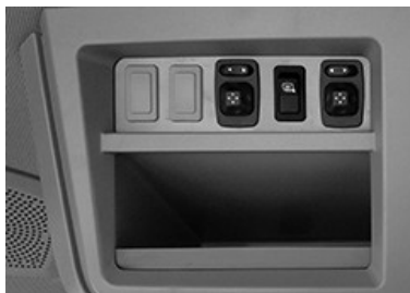
RXA0168462—UN—31MAY19 Exemplo de Controles Elétricos do Retrovisor
