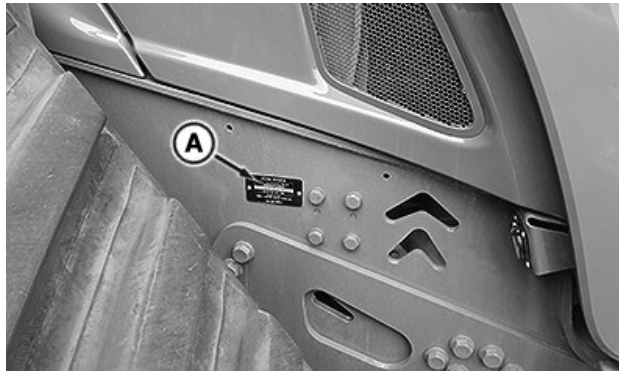
A Placa do Número de Identificação de Produto (A) Está no Lado Direito da Estrutura do Trator
