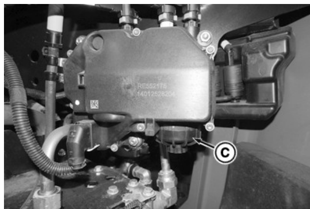
RXA0161214—UN—26OCT17 DEF мөлшерлеу сүзгісі (C) батарея бөлімінде, DEF мөлшерлеу құралының түбінде орналасқан.
