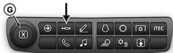
Butonul de comandă rapidă SCV și butonul rotativ de reglare de pe bara de navigare
