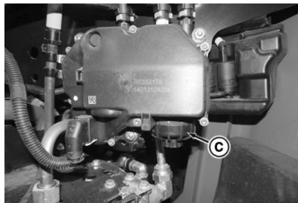
Filtrul unității de dozare a DEF (A) se află în interiorul compartimentului bateriei, în partea inferioară a unității de dozare DEF.
