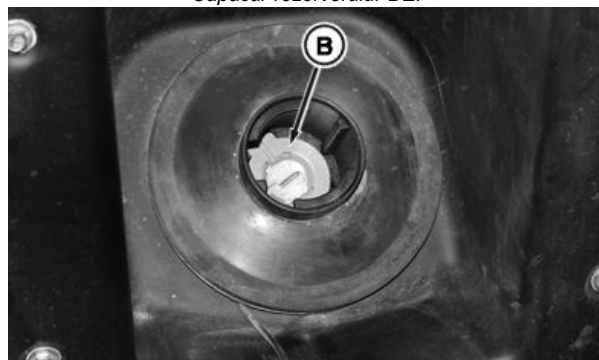
Dispozitiv de fixare a filtrului
