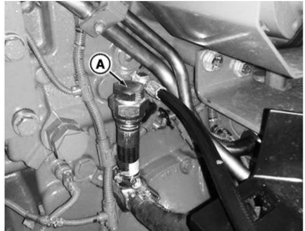
Tubul de umplere a transmisiei e18™
