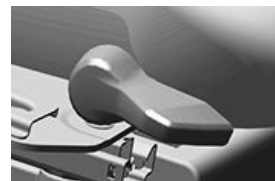
Controlul blocării pivotării
