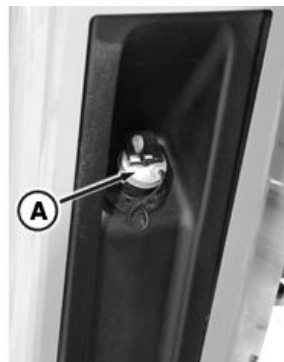
Capacul rezervorului DEF
