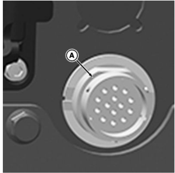
Înșirarea conectorului AutoLoad al cablajului se află deasupra stivei SCV
