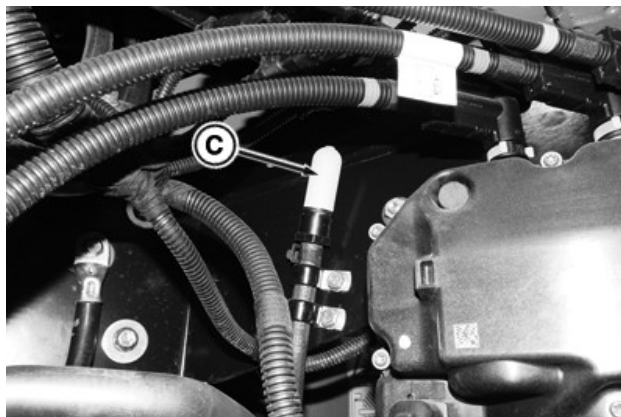
RXA0142031—UN—03JUN14 DEF багының желдету сүзгісі (C) аккумуляторлық батарея бөлімінде, DEF дозаторының үстінде орналасқан.
