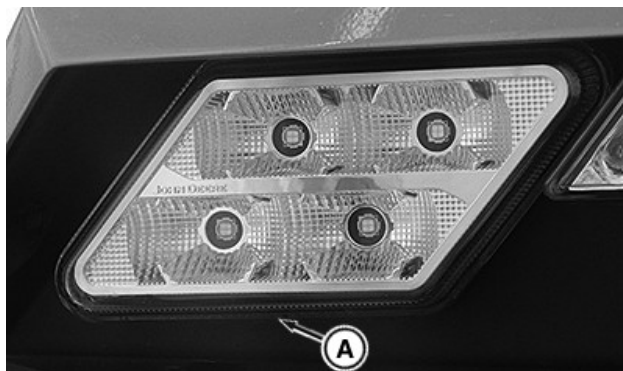
Kabinos stogo žibintas – parodytas LED žibinto pavyzdys
