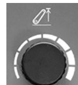
RXA0168029—UN—17MAY19 Prikabinimo įtaiso viršutinės ribos reguliavimo rankenėlė
