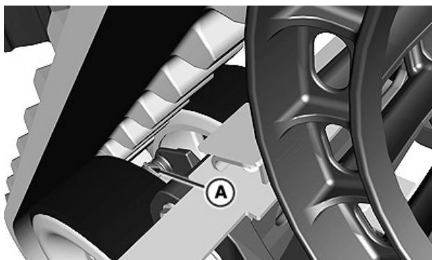
Долна гресьорка на обтягащия цилиндър
