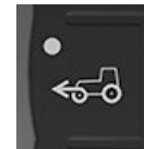
Taste für Frontantrieb
