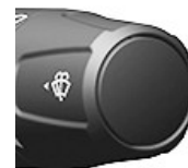
Taste für Frontscheibenwaschanlage
