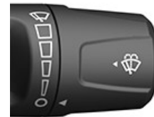
Geschwindigkeit für Frontscheibenwischer
