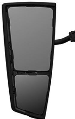
RXA0173907—UN—15JAN20 Beispiel für Spiegel — Doppelspiegel
