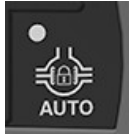
Automatiktaste für Differenzialsperre
