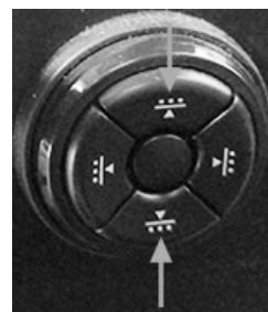
Jostasvietas augstuma regulēšana — "Ultimate"
