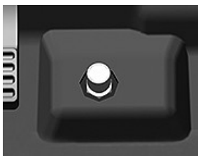
Diferenciāla bloķēšanas grīdas slēdzis
