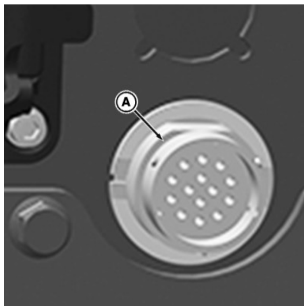
AutoLoad TM vadojuma savienotāja izeja atrodas virs SCV bloka
