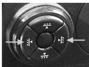
RXA0167333—UN—03APR19 Jostasvietas pagarinājuma regulēšana — "Ultimate"
