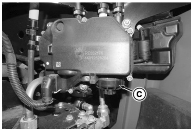
RXA0161214—UN—26OCT17 DEF dozatora filtrs (C) atrodas akumulatora nodaļjumā DEF dozatora apakšā.
