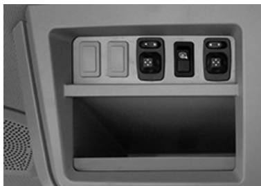
Elektriskā spoguļa vadības ierīču piemērs
