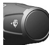
Knapp för vindrutespolare
