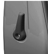
Reglage för svankstödsjustering – Select
