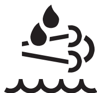
Indikator för dieselavgasvätska
