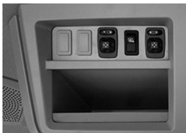
Exempel på reglage för elmanövrerade speglar
