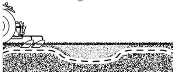
Bei variierenden Bodenverhältnissen führt ein hoher Wert zu größeren Tiefenvariationen. RXA0163993—UN—18JUL18
