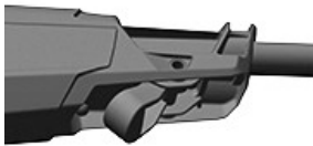
RXA0167461—UN—12APR19 Arretierhebel für manuelle Teleskopfunktion
