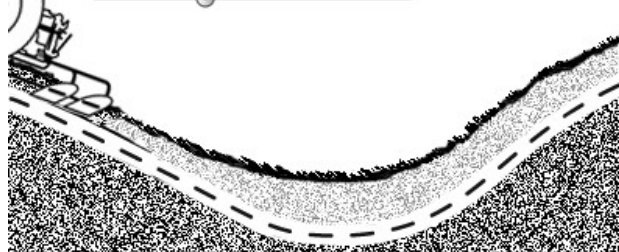
In hügeligem Gelände führt ein niedriger Wert zu größeren Tiefenvariationen. RXA0163995—UN—18JUL18
