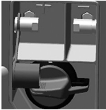
RXA0185275—UN—01SEP21 Les bornes du cavalier de batterie se trouvent près des marches du tracteur.
