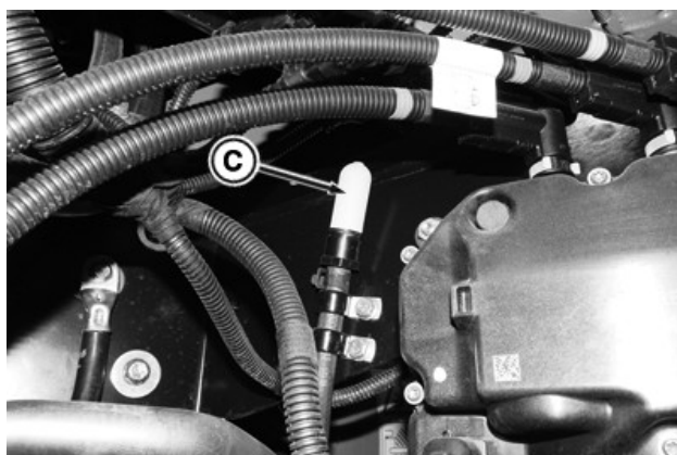
RXA0142031—UN—03JUN14 Le filtre (C) de l'orifice de dégazage du réservoir d'urée DEF se trouve dans le compartiment de batterie, au-dessus du système d'injection d'urée DEF.
