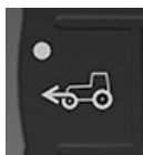
Touche Pont avant
