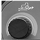
Selector de profundidad de carga del enganche
