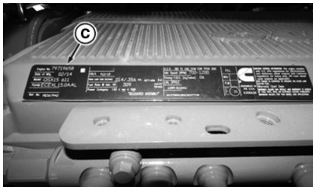
La chapa de identificación del número de serie del motor (C) se encuentra en el lado izquierdo de la cubierta de la válvula del motor
