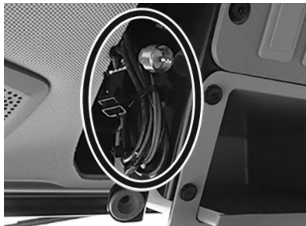
Antena y cables de alimentación
