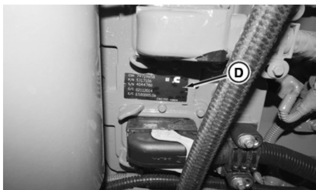
La placa de datos (D) del módulo de control del motor (ECM) se encuentra en el lado izquierdo del motor (en el frontal del ECM)
