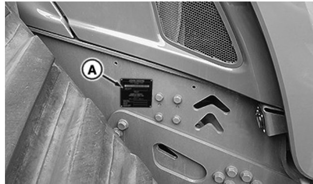
Табличка з ідентифікаційним номером (A) розташована на правому боці рами трактора
