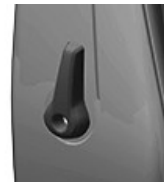
Керування регулюванням поперекової опори . Вибір
