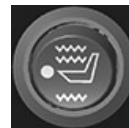
Керування інтенсивністю вентиляції/обігріву (Ultimate)
