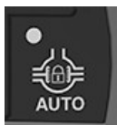
Кнопка автоматичного режиму механізму блокування диференціала
