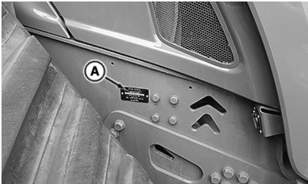
Табличка з ідентифікаційним номером (A) розташована на правому боці рами трактора
