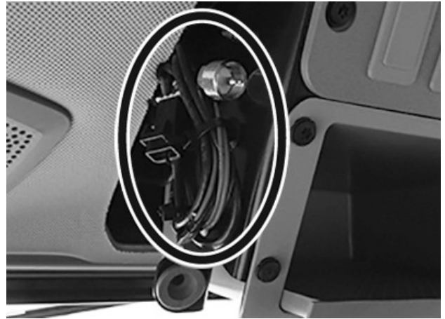
Кабелі антени та силові кабелі
