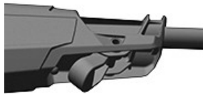
RXA0167461—UN—12APR19 Alavanca de trava telescópica manual
