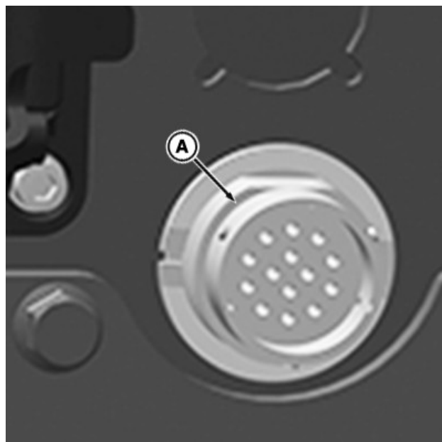
AutoLoad™ жгути улагич розеткаси SCV тўпламидан юқорида бўлади RXA0179346—UN—24AUG20
