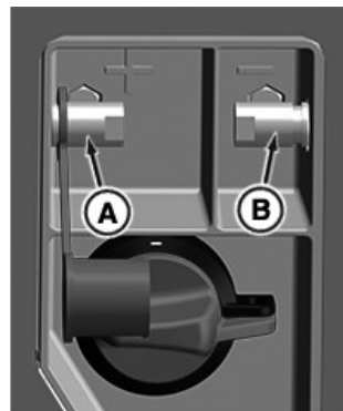
RXA0187645—UN—10AUG22 Akumulatora tīrslēga spaiļes atrodas traktora pakāpienu tuvumā.
