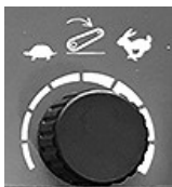
Sakabes nolaišanas ātruma skala
