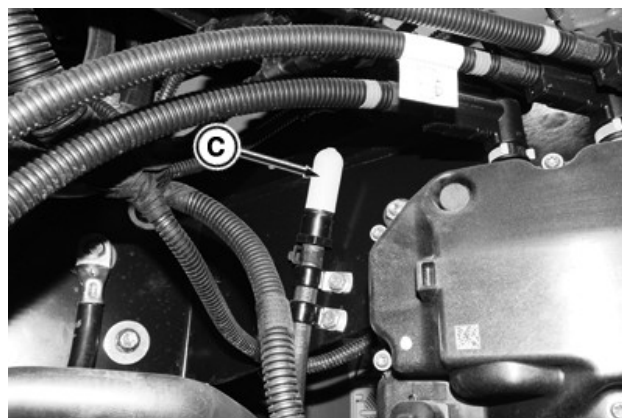
DEF tvertnes ventilācijas filtrs (C) atrodas akumulatora nodalījumā, virs DEF dozatora.
