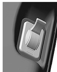
Ručica sekundarne kočnice
