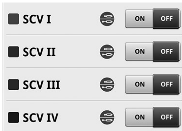
Primjer neovisnog načina rada selektivnih regulacijskih ventila
