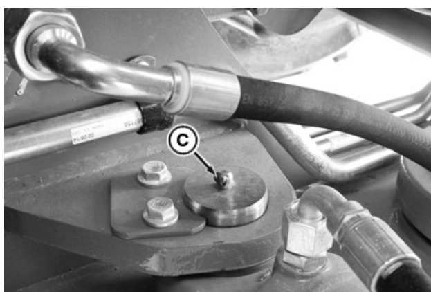
Prednji lijevi zatik upravljača
