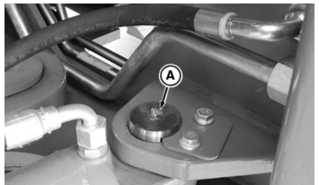
Prednji desni zatik upravljača
