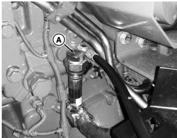
Cijev za punjenje ulja za mjenjač e18™
