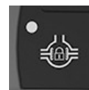
Gumb blokade diferencijala
