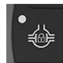
RXA0168427—UN—30MAY19 Bouton de blocage du différentiel
