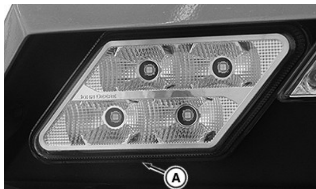
Phare sur pavillon—Option d'éclairage à LED illustrée
