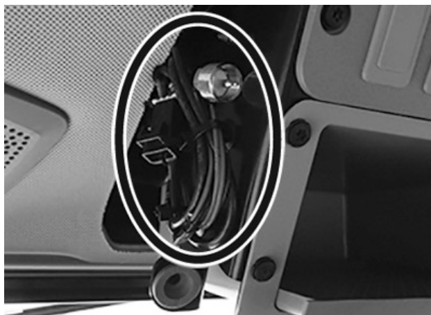
RXA0169831—UN—05AUG19 Antenne et câbles d'alimentation
