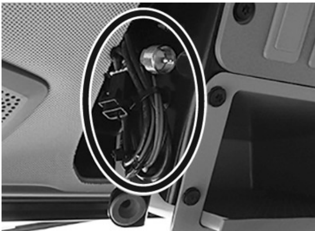
Antena y cables de alimentación
