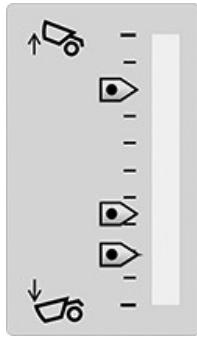
Indicadores de punto de ajuste RXA0180095—UN—09OCT20
