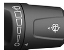
Velocidad del limpiaparabrisas delantero
