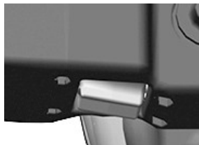
Control de inclinación del reposabrazos
