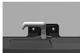
Palanca de la ventana trasera
