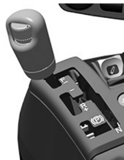
Inversor con mando en lado derecho
