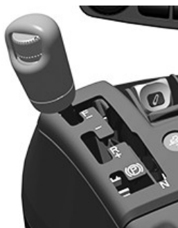
Ejemplo de control de velocidad/cambio
