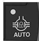
Botón de bloqueo del diferencial automático
