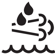
RG22487—UN—21AUG13 Indicador de fluido de escape diésel
