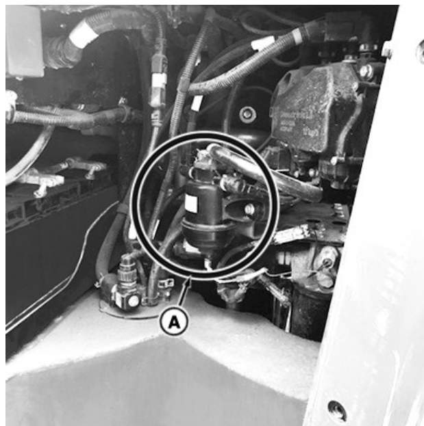
Линейният филтър за DEF (A) се намира в акумулаторното отделение.
