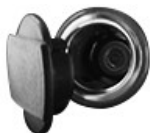
RXA0167981—UN—17MAY19 Izlaz za dodatnu opremu od 12 V
