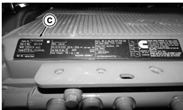
Motorens serienummerplade (C) findes på venstre side af motorventildækslet
