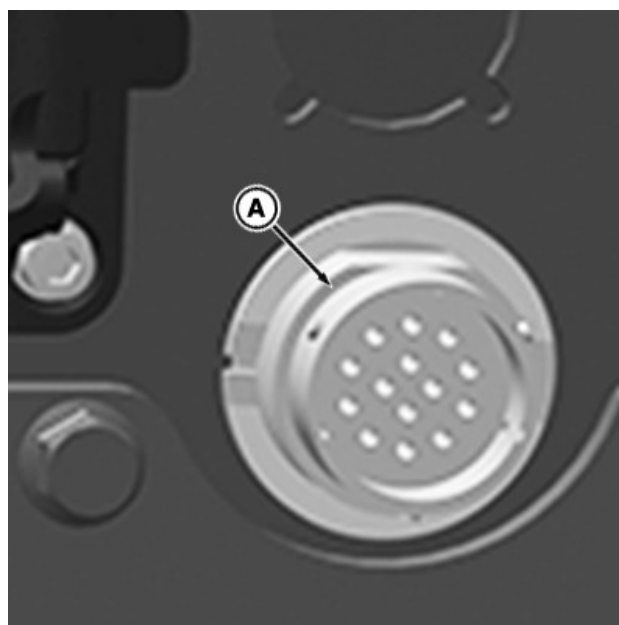
RXA0179346—UN—24AUG20 AutoLoad™ ledningstilslutning befinder sig over SCV-gruppen
