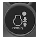
Funktionstast til motorens manuelle tilstand
