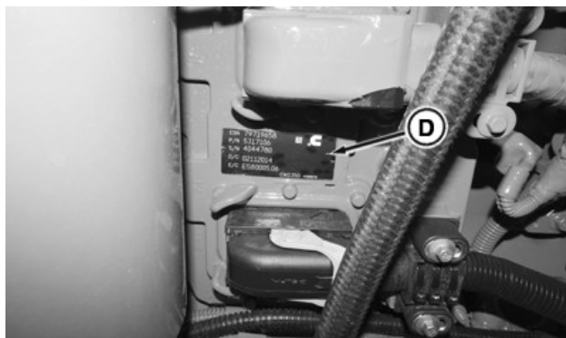
Datapladen (D) på motorens styremodul (ECM) findes på venstre side af motoren foran ECM
