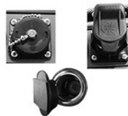
РХА0169780—UN—30JUL19 Розетки для дополнительного оборудования 12 В
