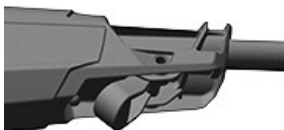
РХА0167461—UN—12APR19 Рычаг блокировки телескопической регулировки вручную
