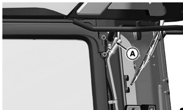
Вентиляційний фільтр паливного бака (А) — ліва кутова стійка кабіни RXA0180432—UN—12NOV20
