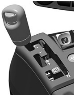
Beispiel für Geschwindigkeits-/Schalthebel
