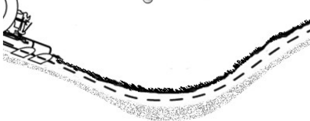
In hügeligem Gelände führt ein hoher Wert zu geringeren Tiefenvariationen. RXA0163996—UN—18JUL18
