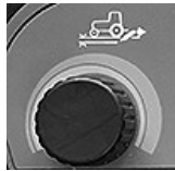
Drehknopf für Zugwiderstand/Tiefe des Krafthebers
