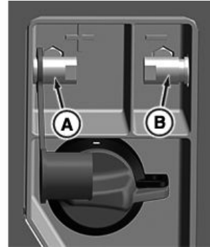
Os terminais de ligação da bateria estão localizados próximos aos degraus do trator.
