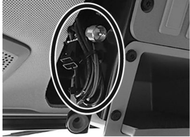
Antena e cabos de alimentação
