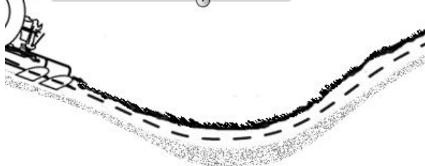
Em terreno ondulado, valor alto causa menos variação de profundidade.
