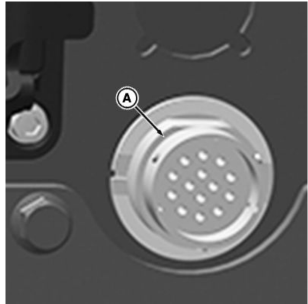
Saída do Conector do Chicote Elétrico AutoLoad Acima do Conjunto da VCR
