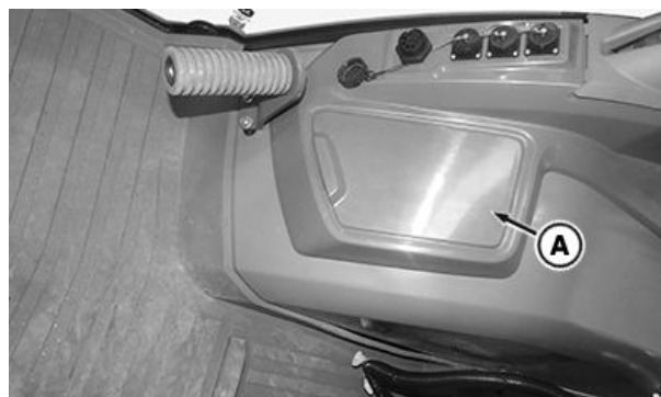
Painel Lateral Traseiro (A) na parte inferior direita do assento do operador
