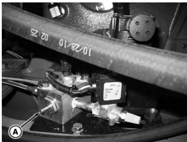
RXA0114907—UN—09MAY11 Soupape d'évacuation au-dessus de l'essieu de suspension
