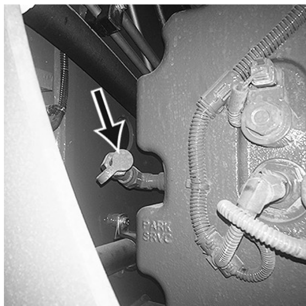
RXA0182921—UN—10MAY21 Diagnosztikai csatlakozó (F)
