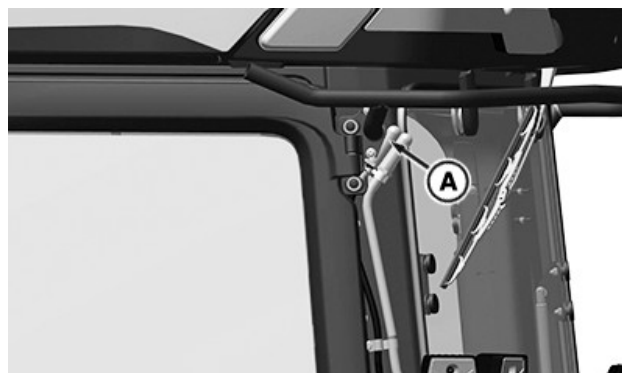
RXA0180432—UN—12NOV20 Filtro di sfiato serbatoio del carburante (A) — Montante d'angolo cabina lato posteriore sinistro
