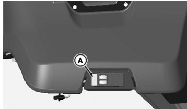
A—Etichetta lato sinistro (lato posteriore sinistro del serbatoio del carburante)
