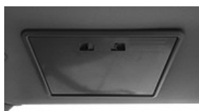
RXA0167997—UN—17MAY19 Portaoggetti sul tetto
