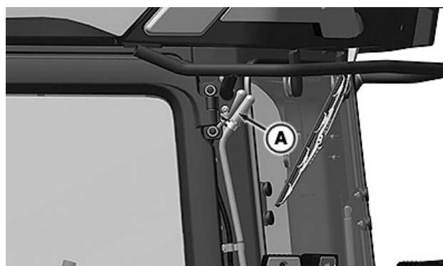
Il filtro di sfiato del serbatoio DEF (A) è vicino alla parte superiore dell'angolo posteriore sinistro della cabina.
