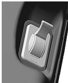
Betjeningshåndtag til nødbremse
