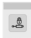
Hydraulikudtag er låst
