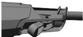
RXA0167461—UN—12APR19 Manuelt låsehåndtag til teleskopfunktionen
