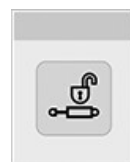
Hydraulikudtag er ikke låst
