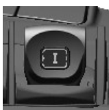
Håndtag til hydraulikudtag I
