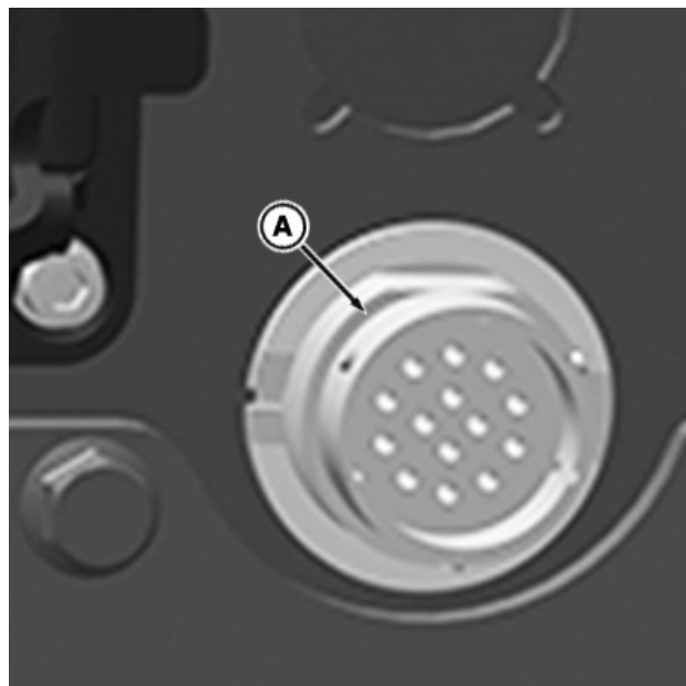
AutoLoad-ledningstilslutning befinder sig over SCV-gruppen
