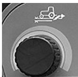
Drejegreb til træktøjets belastningsdybde
