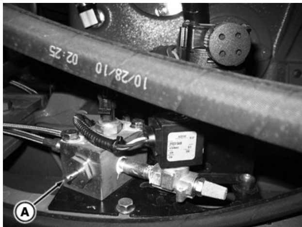
Spiediena izlīdzināšanas vārsts – virs balstiekārtas ass
