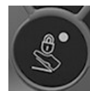
RXA0168434—UN—30MAY19 Ātruma vadības pedāļa bloķēšanas poga
