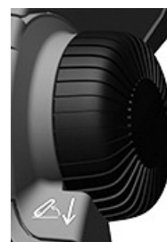
RXA0168025—UN—17MAY19 Sakabes darba dziļuma regulēšanas skala
