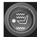
Reglage för ventilations-/värmeintensitet – Ultimate
