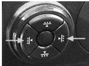
Reglage för svankstödsutvidgning – Ultimate
