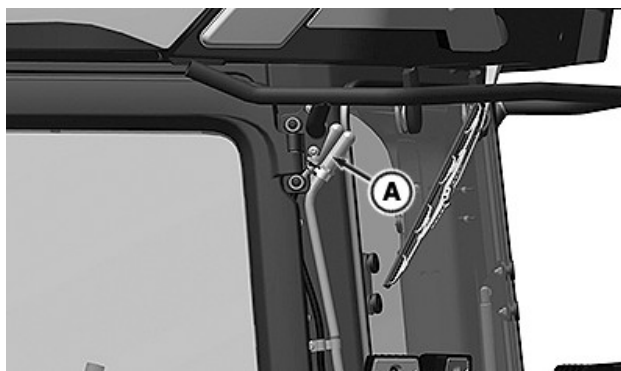
RXA0180428—UN—11NOV20 DEF-tankens ventilationsfilter (A) är nära hyttens bakre, vänstra hörn.
