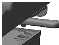
Reglage för spärr av dämpning åt vänster/höger
