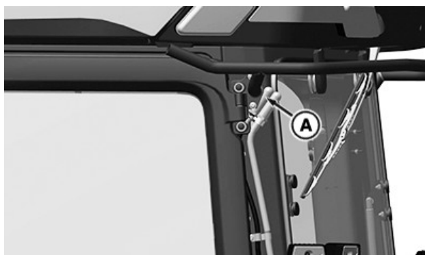
Bränsletankens ventilationsfilter (A)—Vänster hörnstolpe baktill på hytten
