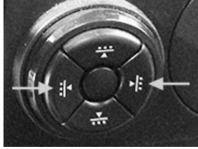
RXA0167333—UN—03APR19 Reglage för svankstödsutvidgning – Ultimate
