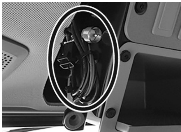
Przewody antenowe i zasilania
