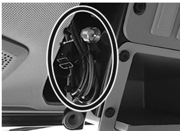
Антенна и захранващи кабели
