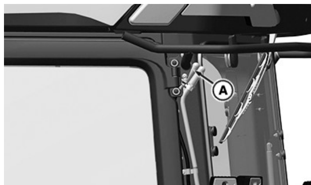
Odvdzušňovací filter palivovej nádrže (A)-ľavý zadný rohový stĺpik kabíny
